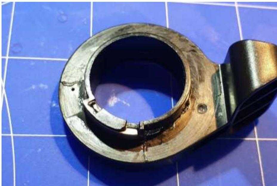
4. Nach trocknen des Klebers ( ca 5 – 10 min warten ), eventuell überschüssige Klebereste mit Schleifpapier entfernen. Sonst kann es sein das der Hebel leicht klemmt. Etwas Vaseline an die beweglichen Teile schmieren.
