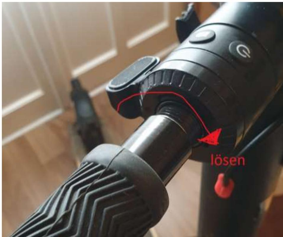
2. Kleine Inbusschraube mit dem 3,0 Inbus lösen ( zwei, drei Umdrehungen )
