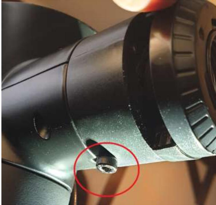
3. Jetzt je 2 Schrauben links und rechts von unten, mit dem Kreuzerschlitzschraubendreher rausdrehen
